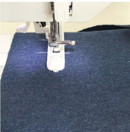
На деталях капюшона поочередно обметать петли по разметке с лицевой стороны на швейной машинке, используя лапку для выметывания петель.
