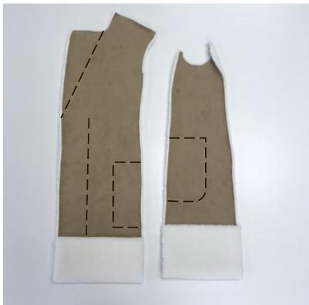
Перенести с лекал на детали полочки и бочка линии расположения карманов, линии перегиба лацкана и линии полузданоса. По линиям проложить ручные стежки контрастными нитками.
