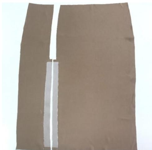
На деталях переднего полотнища юбки продублировать припуски шва разреза полосками дублерина шириной 2 см, длину замерить по лекалам. На детали с лекал перенести линии перегиба припуска шва в месте разреза. По линии ручным стежком проложить контрольную строчку.
