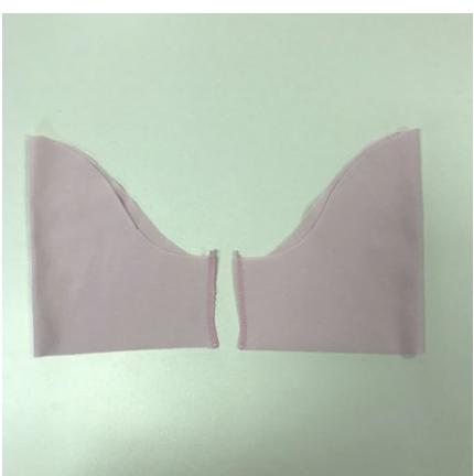
Детали рукавов сложить пополам лицевой стороной внутрь по боковым срезам. Сколоть булавками, сметать, стачать на оверлоке. Стачивающе-обметочную строчку прокладываем, как показано на фото. Шов стачивания приутюжить. Шов заутюжить на сторону переда.
