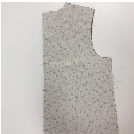
Детали спинки сложить лицевыми сторонами внутрь по среднему срезу. Сколоть булавками, сметать, стачать на швейной машинке. Строчку прокладывать от нижнего среза спинки до контрольной точки, обозначающей глубину разреза.
