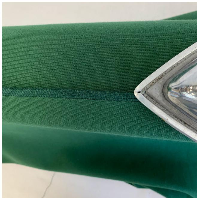
Выполнить влажно-тепловую обработку (далее – ВТО) боковых швов на универсальной колодке, первоначально приутюжив их, а затем заутюжив припуски в сторону переда.
