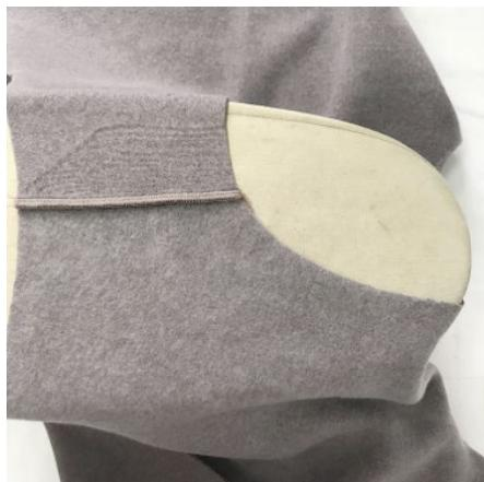
Выполнить влажно-тепловую обработку (далее – ВТО) плечевых швов на универсальной колодке, первоначально приутюжив их, а затем заутюжив припуски в сторону спинки.
