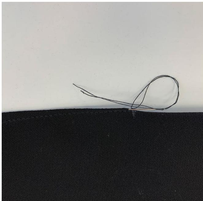
Стачать на машинке, прокладывая строчку от среза до вершины вытачки. В начале строчки поставить закрепку, в конце строчки оставить концы нитей, завязать узелок и убрать концы нити в глубину вытачки при помощи иголки с большим ушком.
