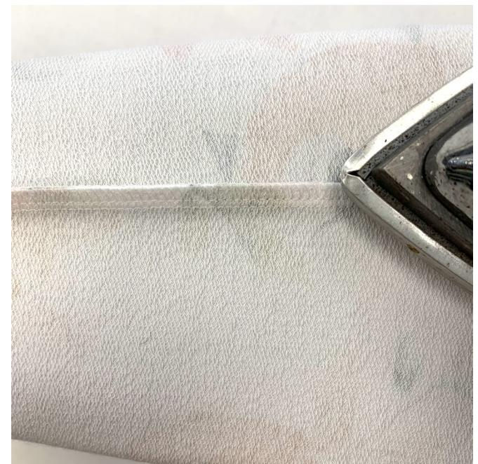
Шов стачивания приутюжить, припуск шва заутюжить на сторону задней половинки.
