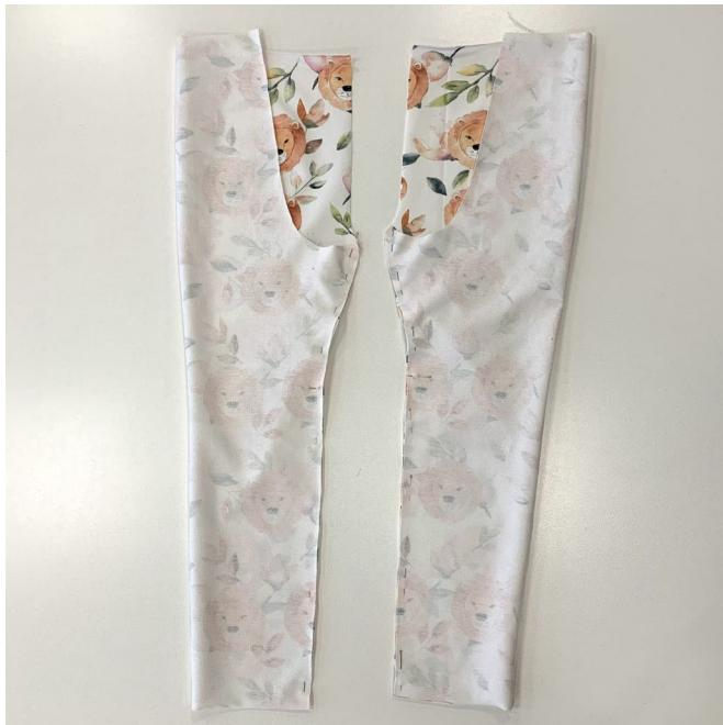
Сложить детали передней половинки брюк и задней половинки брюк лицом к лицу по шаговому шву, совмещая контрольные надсечки. Сколоть, сметать и стачать на оверлоке, проложив стачивающе-обметочную строчку по припуску со стороны передней половинки брюк.
