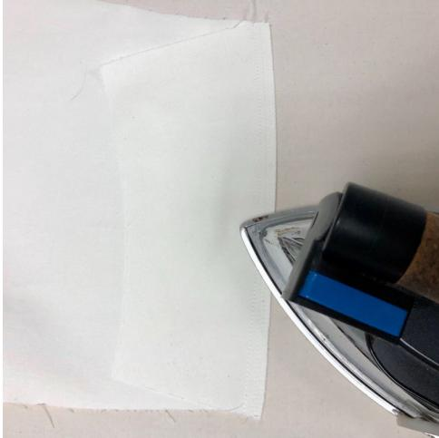
Выполнить влажно-тепловую обработку (далее – ВТО) шва притачивания. Для этого припухшую шву приутюжить.
