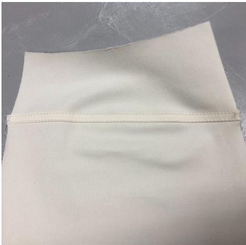
Припухшую шву притачивания кокетки насторочить на кокетку двумя параллельными строчками. Строчки прокладывать по лицевой стороне кокетки, отделочными нитками на расстоянии 0,2 и 0,9 см от шва притачивания кокетки. Длина стежка 0,4 см.
