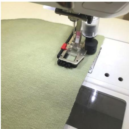
На деталях капюшона поочередно выметать петли по разметке с лицевой стороны, используя лапку для выполнения петель на швейной машине. По окончании прорезать петли распарывателем, предварительно вколоть булавки-ограничители в начале и конце петли.
