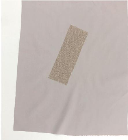
Перед дублированием основных деталей изделия рекомендуем проверить и продублировать дублерином и/или kleевой кромкой отдельный отрез основного материала. А также проверить настройки утюга: температуру, пар (возможно ли дублирование исходного материала с паром) и время выдержки, которое потребуется на приклеивание kleевого материала к основному.
