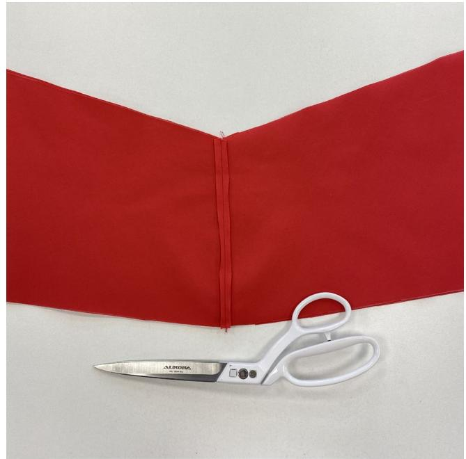
Швы приутюжить, припуски разутюжить. Припуски шва срезать до 0,5 см.
