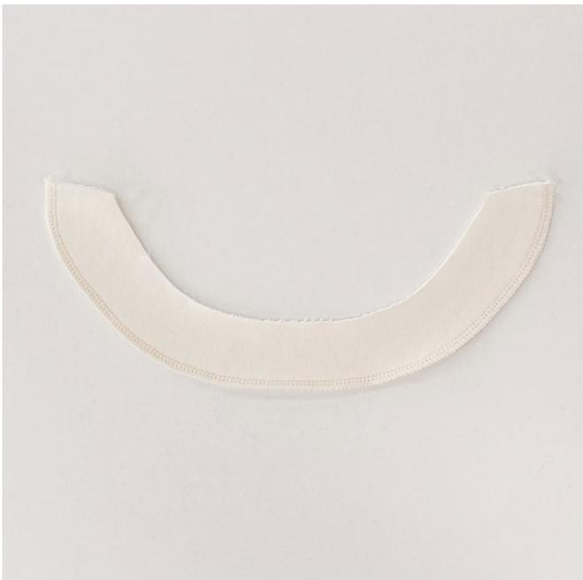
Деталь обтачки горловины обработать на оверлоке, прокладывая строчку с лицевой стороны детали вдоль нижнего среза.
