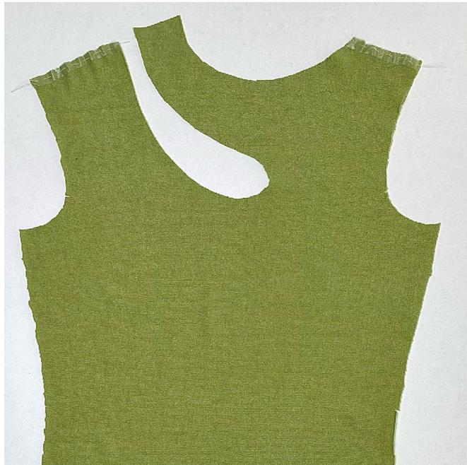
На деталь переда с изнаночной стороны приметать силиконовую ленту вдоль припуска по плечевым срезам.
