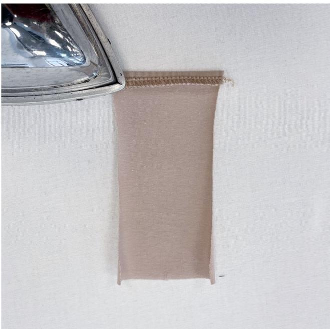
Заутюжить припуск ластовицы на изнаночную сторону, уравнивая срез к намеченной линии.
