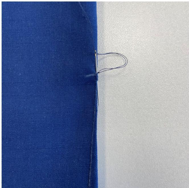
Стачать вытачки, выполняя закрепки у среза. У вершины вытачки завязать нитки в узелки и с помощью иглы заправить между слоями материала.
