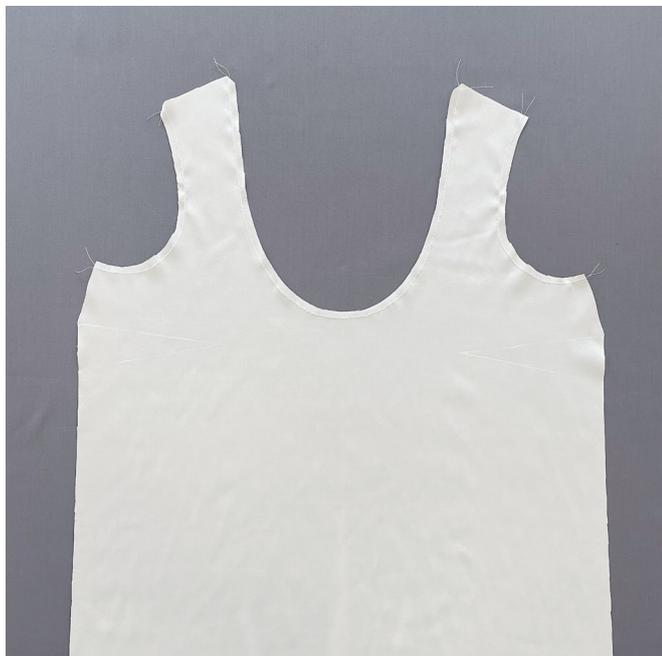
Перед пошивом изделия для предотвращения растяжения срезов деталей необходимо проложить вдоль срезов технические строчки на швейной машинке.
