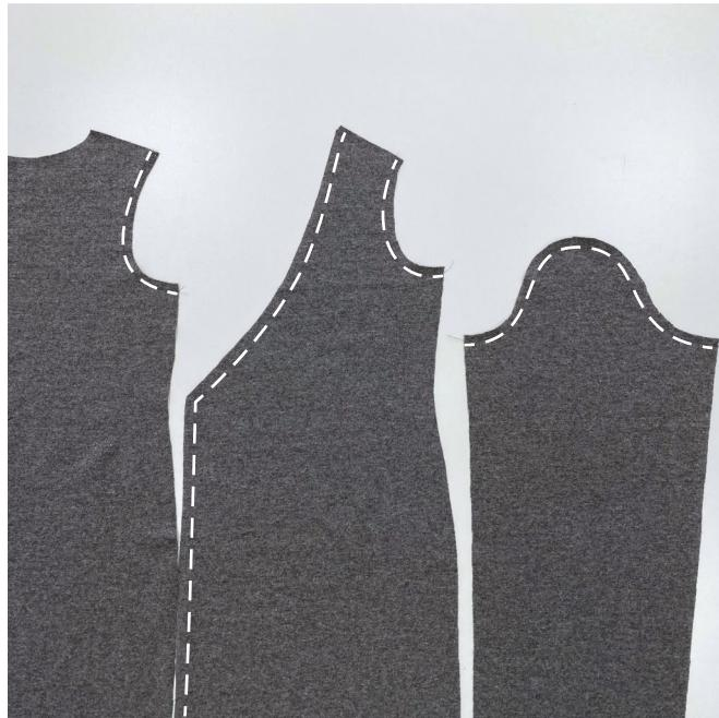
Перед пошивом изделия для предотвращения растяжения срезов деталей необходимо проложить вдоль срезов технические строчки на швейной машинке на расстоянии 9 мм от среза без закрепок.
