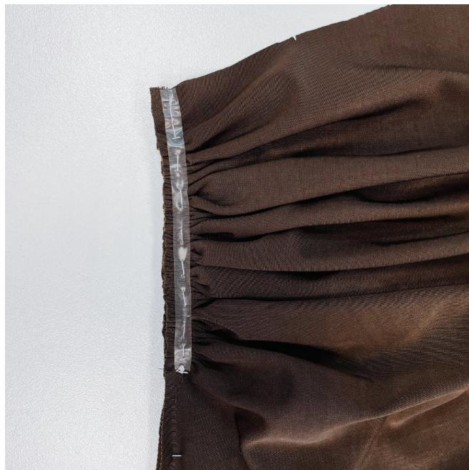
Вдоль среднего среза со стороны детали правой нижней части переда на участке сборки приметать силиконовую ленту для предотвращения шва от растяжения.
