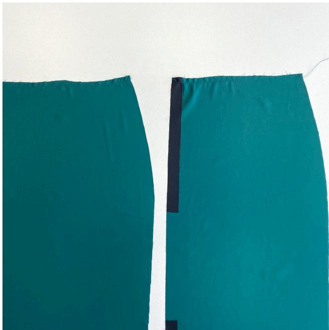
Для предотвращения срезов деталей от растяжения необходимо проложить вдоль срезов технические строчки на швейной машинке на расстоянии 9 мм от среза без закрепок:
