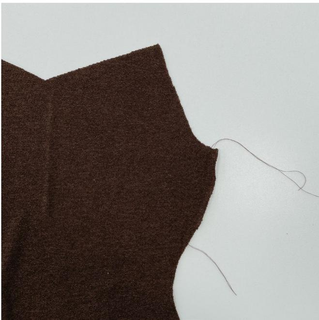
На детали переда по боковым срезам на участке между контрольными надсечками проложить строчку на швейной машинке без закрепок. Оставить длинные концы нитей.
