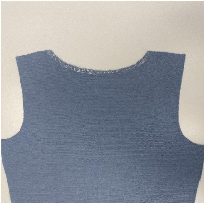
На деталь спинки с изнаночной стороны приметать силиконовую ленту вдоль припуска по срезу горловины.
