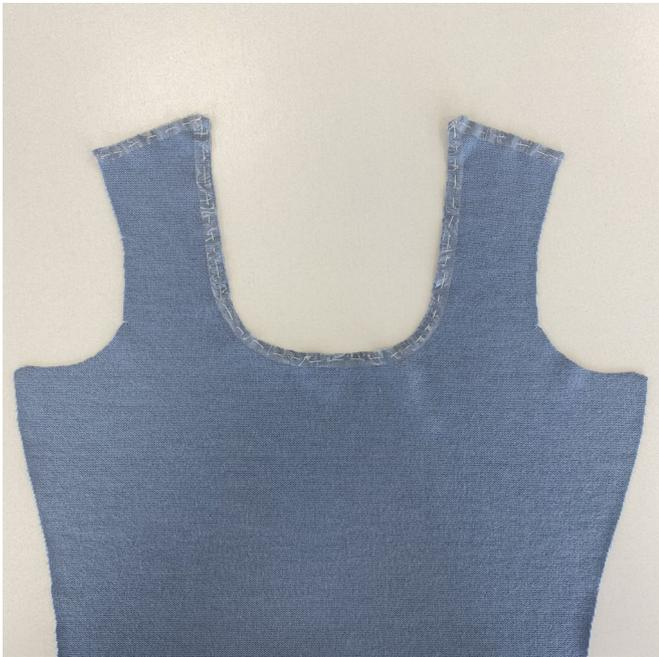
На деталь переда с изнаночной стороны приметать силиконовую ленту вдоль припуска:
