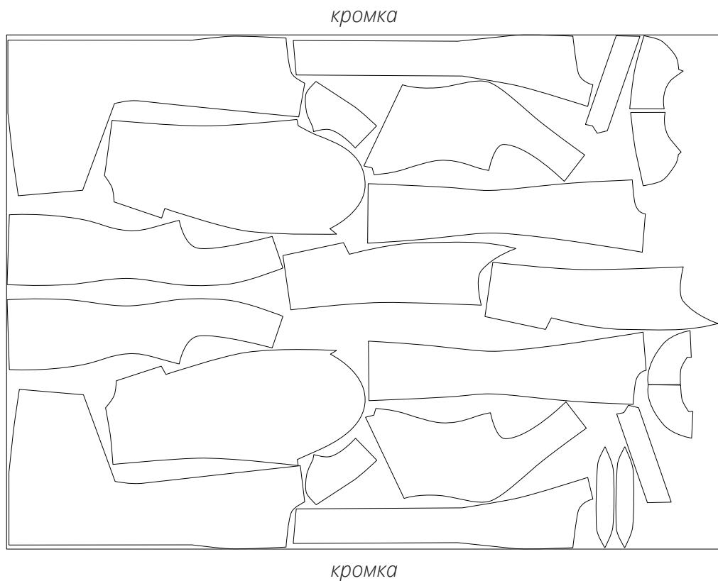
План раскладки выкройки на подкладочном материале шириной 140 см для раскroя в сгиб для размера 34 всех ростов с учетом направления рисунка
