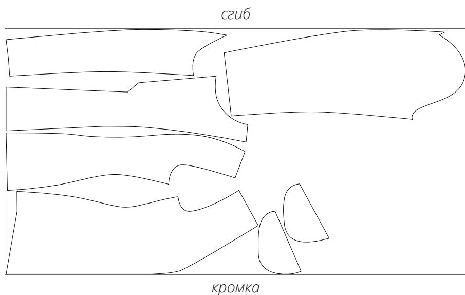
План раскладки выкройки на подкладочном материале шириной 140 см для раскroя в сгиб для размеров 36-44 всxх ростов с учетом направления рисунка
