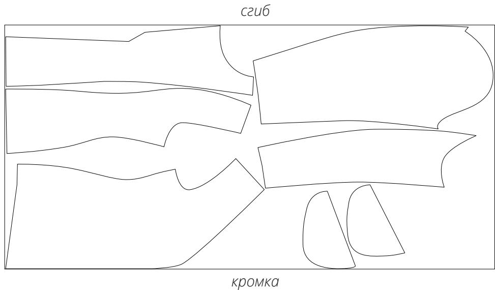
План раскладки выкройки на подкладочном материале шириной 140 см для раскroя в сгиб для размеров 46-52 всxх ростов с учетом направления рисунка
