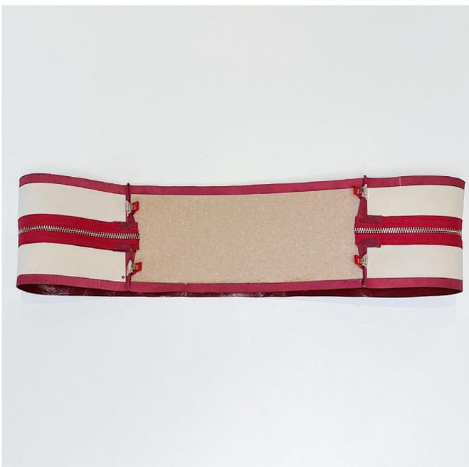
Детали ботана сумки и дна сумки сложить лицевыми сторонами внутрь, уравнивать по коротким срезам. Удалить защитный слой трансферной ленты на детали ботана и приклеить деталь дна сумки, зафиксировать зажимами. Стачать на швейной машинке без закрепок. Концы нитей завязать узелком и срезать до 3-5 см.
