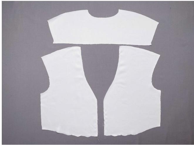
Перед пошивом изделия для предотвращения растяжения срезов деталей необходимо проложить на деталях технические строчки на швейной машинке.
