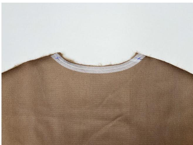
На детали спинки с изнаночной стороны намелить частично линии плечевого шва и горловины для получения точек пересечения припусков.
