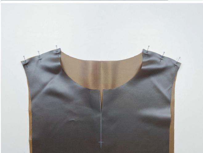
Детали подкладки переда и подкладки спинки сложить лицевыми сторонами внутрь. Уровнять плечевые срезы, сколоть булавками. Стачать на швейной машинке. Выполнить закрепки в начале и в конце строчки.
