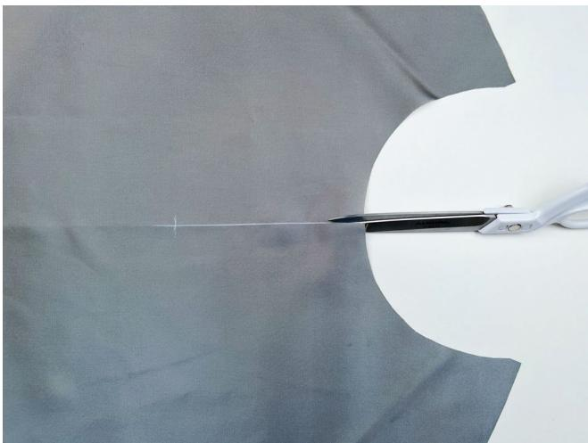
На детали подкладки переда выполнить разрез по намеченной линии длиной 4-5 см.
