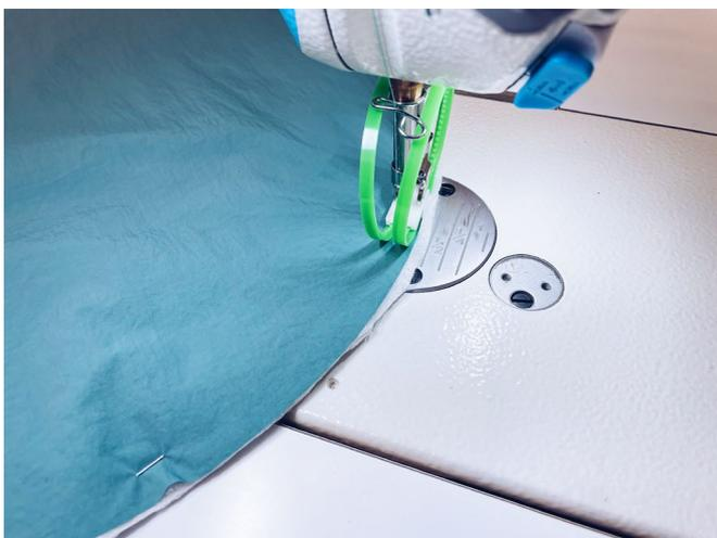
Простегать на швейной машинке детали из списка выше при помощи специальной лапки. Строчку проложить отступая от края срезов на 5 мм. Ширина стежка 4 мм. Без закрепок.
