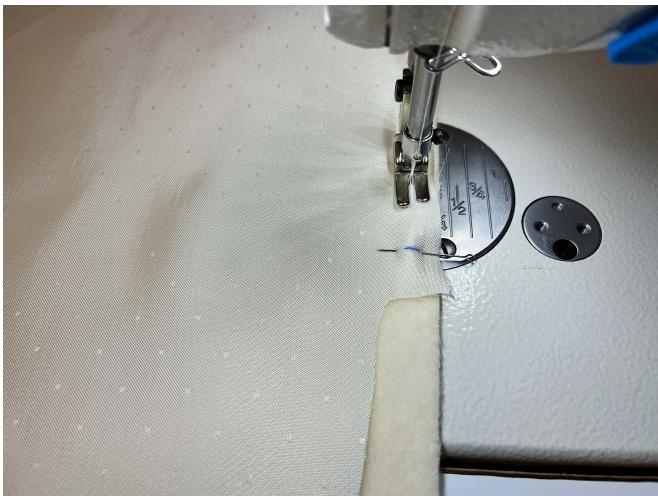
2. Притачать подкладку кармана на швейной машинке с закрепками. Строчку проложить на участке между контрольными надсечками.
